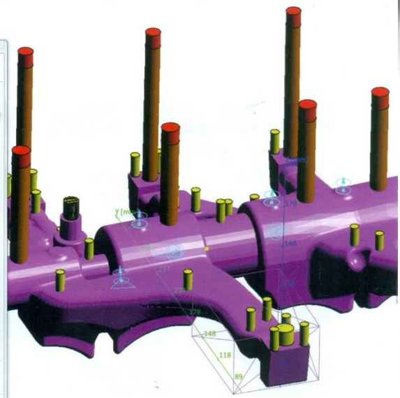
При помощи параметрической базы данных в MAGMA C+M могут быть рассчитаны вентиляционные сопла
