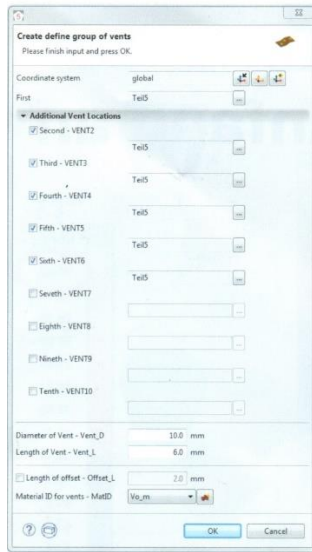
При помощи параметрической базы данных в MAGMA C+M могут быть рассчитаны вентиляционные сопла
