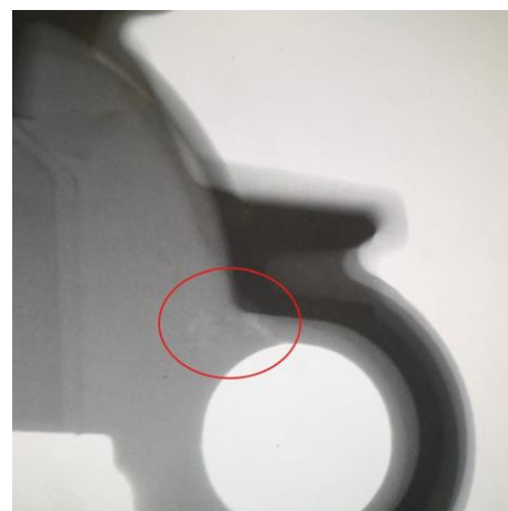
Рис. 2: Рентгеновский анализ подтверждает предположение инженеров: прототип обнаруживает пористость (показано красным), что недопустимо при серийном производстве.
