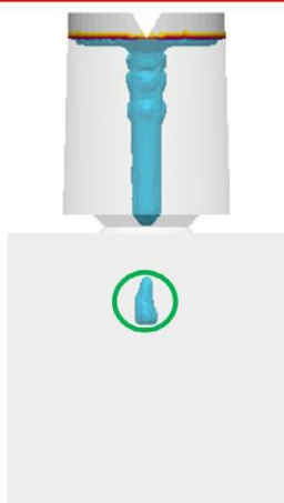
Рис. 2: Литейщики рассчитали с MAGMASOFT® пористость куба для обеих прибылей и изготовили прототип: цилиндрическая прибыль (внизу) не позволяет избежать усадочной пористости.
