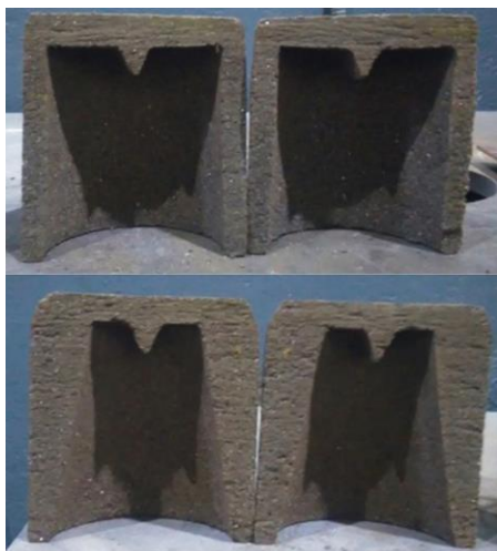
Рис. 1: Различные гильзы: сверху - стандартные, внизу - конические
