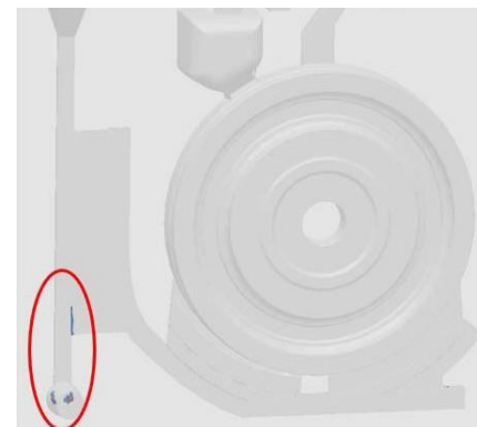
Рис. 2: Существенной проблемой оказалась эрозия формы, в результате чего песок проникал в полость
