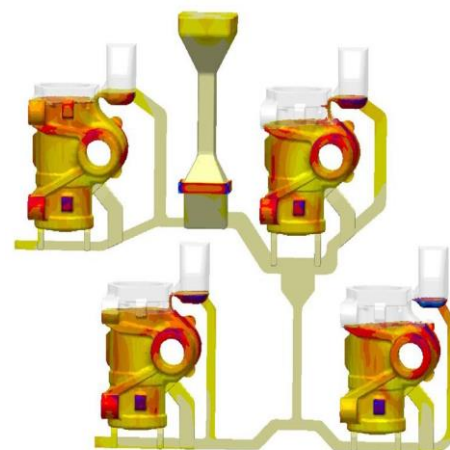
Рис. 4: Предыдущая ЛПС обуславливает преждевременное охлаждение и окисление расплава, следствием чего являлось недостаточное питание отливки.
